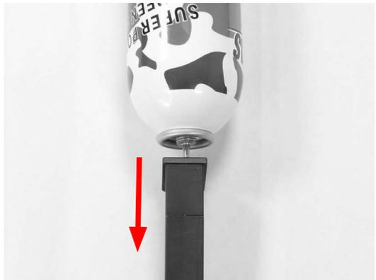
FILL THE GAS BOTTLE TO THE MAGAZINE IN VERTICAL DIRECTION.
